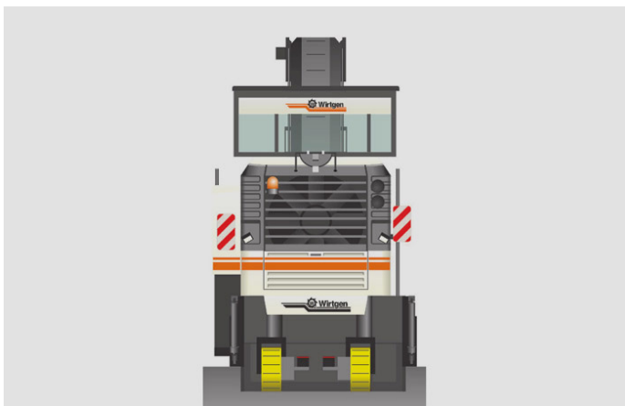
Heckansicht einer Großfräse. Die hinteren Fahrwerke laufen auf der Fräsfläche.
