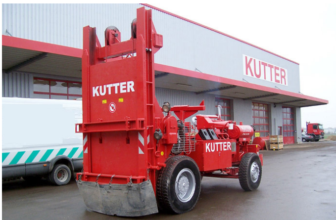
Alte Technik – neu aufgearbeitet: Der Betonzertrümmerer ist unverzichtbar beim Rückbau großer Betonverkehrsflächen.
