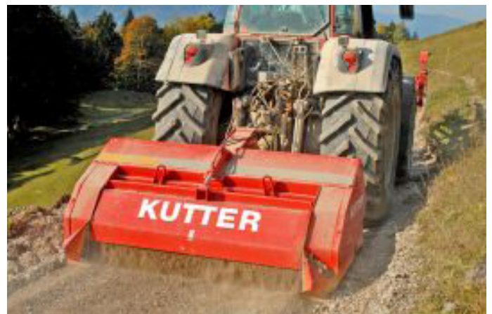
Der Steinbrecher zerkleinert das Material an Ort und Stelle.
